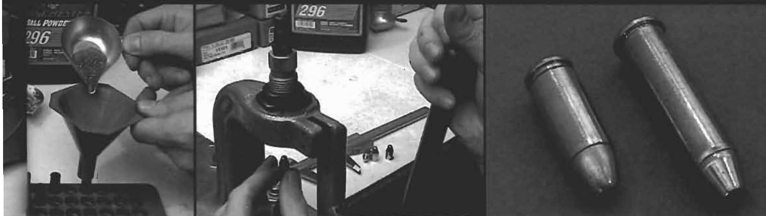
I due tipi di crimpatura (a sin. 9x21 con taper crimp a dx. 357 mag. con roll crimp)
